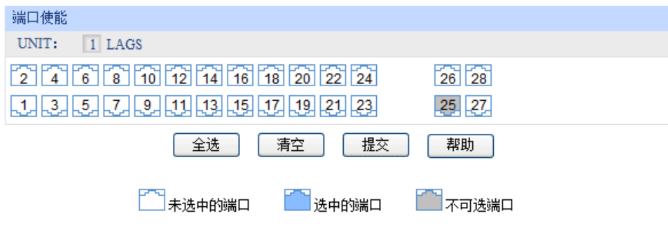
图 7-8 端口使能 MAC VLAN 特性
